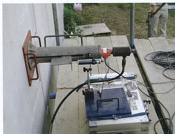
【幅広ストリップの引抜試験状況】
