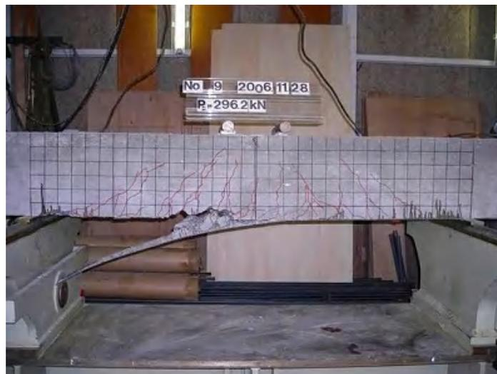
ストランドシートによるRCはりの曲げ補強効果確認試験
